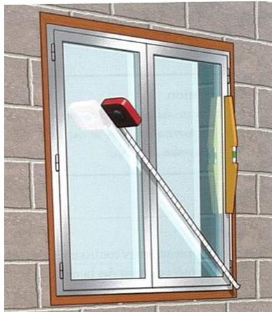
Figure 11 : Mesure des tolérances dimensionnelles de positionnement de la fenêtre
