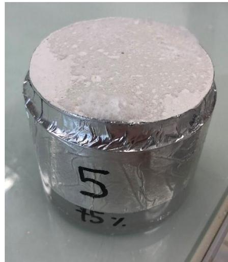
Figure II-3. Coupelle standard format 7cm de diamètre
