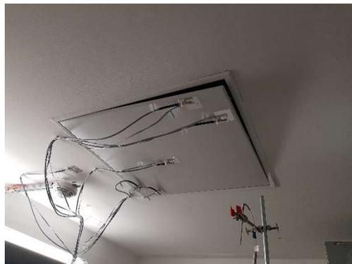
La phénoménologie liée au premier défaut est simple. Il s'agit d'un manque d'isolation dont l'impact se mesure directement par l'évaluation de la différence de flux pour chaque valeur de différence de température entre la cellule et le volume de comble au-dessus.
