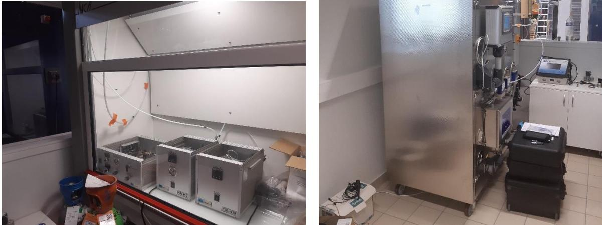
Figure 21 : Chambre d'essai d'1 m<sup>3</sup> et système de génération de Composés Organiques Volatils par des fours et des tubes à perméation.
