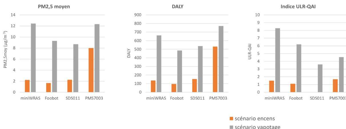
Figure 41 : Ecart absolu, par rapport au scénario 1, des indices de QAI calculés à partir des capteurs à bas coût et de la référence.
