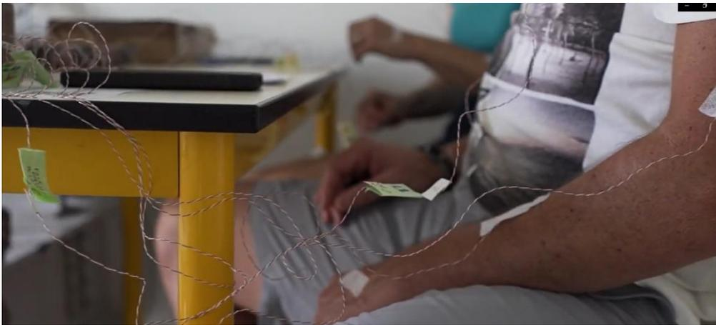
Figure 51 : Mesure de la température de la peau des sujets avec la méthode des thermocouples directement apposés sur les différentes parties du corps.
