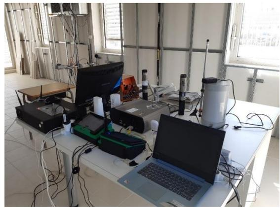
Figure 19 : Présentation du dispositif et des appareils métrologiques utilisés lors de l'essai réaliste en condition cuisine.
