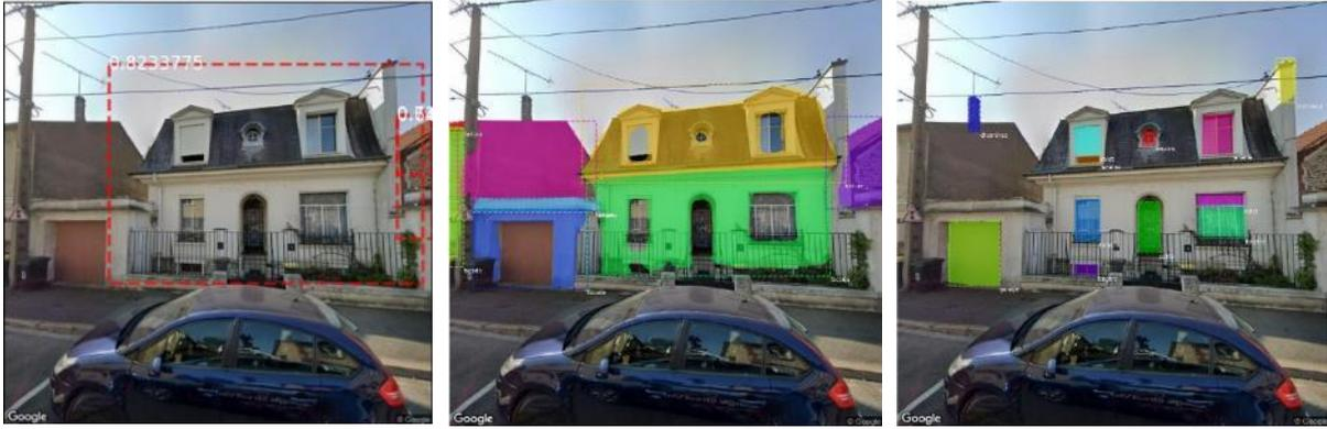
Figure 9 : Résultats obtenus pour les trois réseaux de neurones. A gauche : le résultat de la détection de maison individuelle. Au centre : le résultat de la segmentation des catégories façades et toitures. A droite : le résultat de la segmentation des catégories fenêtres et autres éléments
