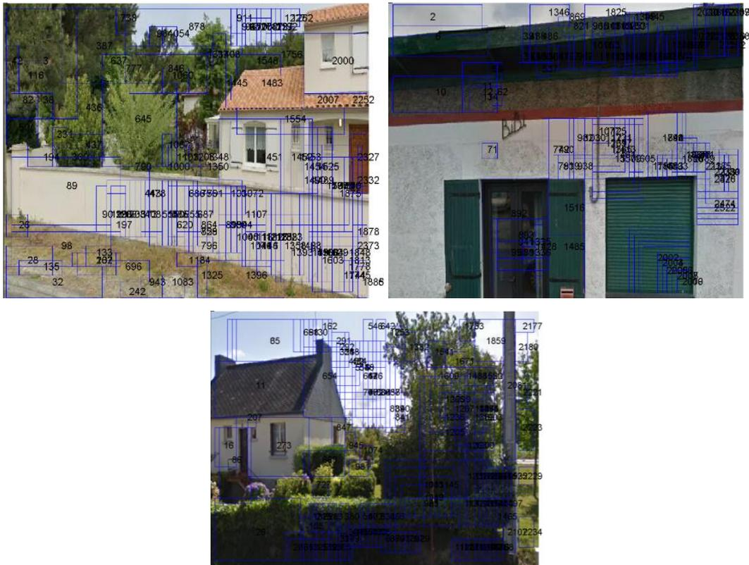
Pour une image donnée, pour chacun des 3 canaux de couleur, une intercorrélacion 2D normalisée va être réalisée entre l'image formée par la norme du gradient de l'image sur un canal donné et la norme du gradient de l'imagette sur le même canal. Le maximum d'intercorrélacion en valeur absolue va alors être stocké ainsi que la moyenne de l'intercorrélacion sur l'image. Une imagette va donc fournir 6 informations.
