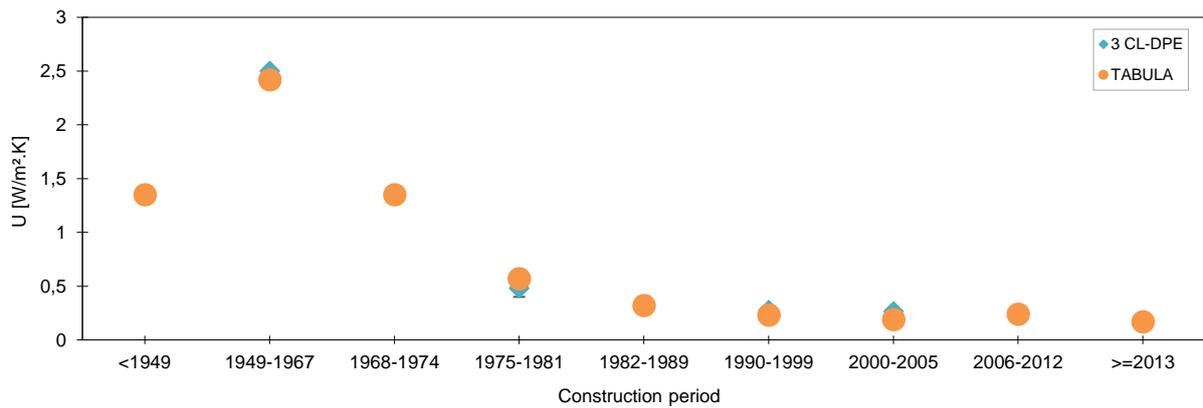
Figure 4 : Comparaison du coefficient de transmission thermique U pour le plancher haut.
